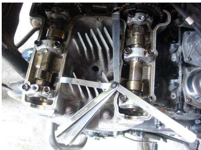
Passer les cales entre la came et la pastille. Pour l'échappement, la cale de 15 doit passer facilement mais pas la cale de 20. Pour l'admission, la cale de 10 doit passer mais pas celle de 15
