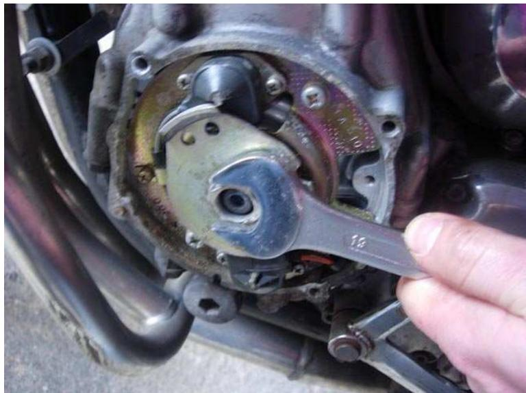
1/ virer le cache arbres à cames et le carter d'allumeur en bas à gauche pour pouvoir tourner le vilebrequin (et par conséquent les arbres à cames) avec une clef de 19 :
