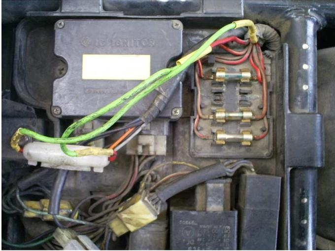
On débranche la batterie, on dévisse les 2 vis de fixation du boîtier et on sort celui-ci
