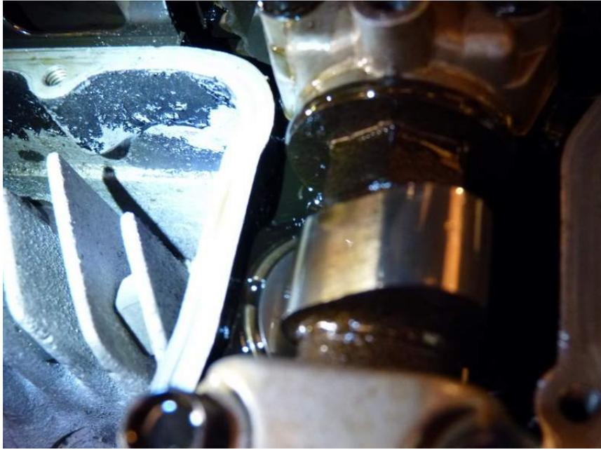
Tourner le vilebrequin en sens inverse d'horloge jusqu'à ce que la soupape concernée soit enfoncée au maximum.
