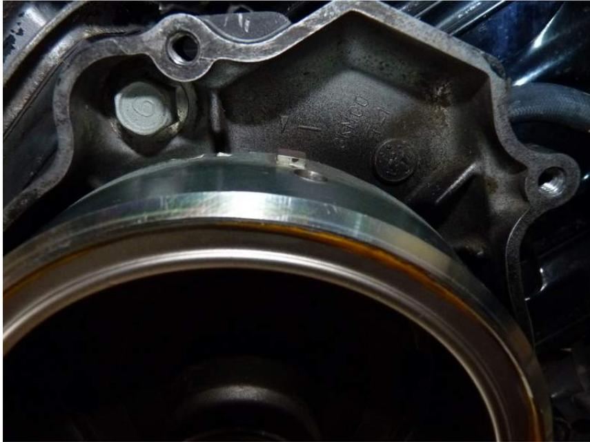
Cylindre 3 encore un demi tour dans le sens inverse avec le T pour repère, comme pour le numéro 1. Idem pour le cylindre 4 toujours en tournant en sens inverse mais avec le même repère que pour le cylindre 2. On a donc effectué à la fin des contrôles deux tours de vilebrequin ce qui correspond à un cycle entier du moteur 4 temps.
