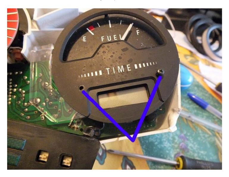
Débranchez la connectique et enlevez le bouchon de passage du faisceau.
