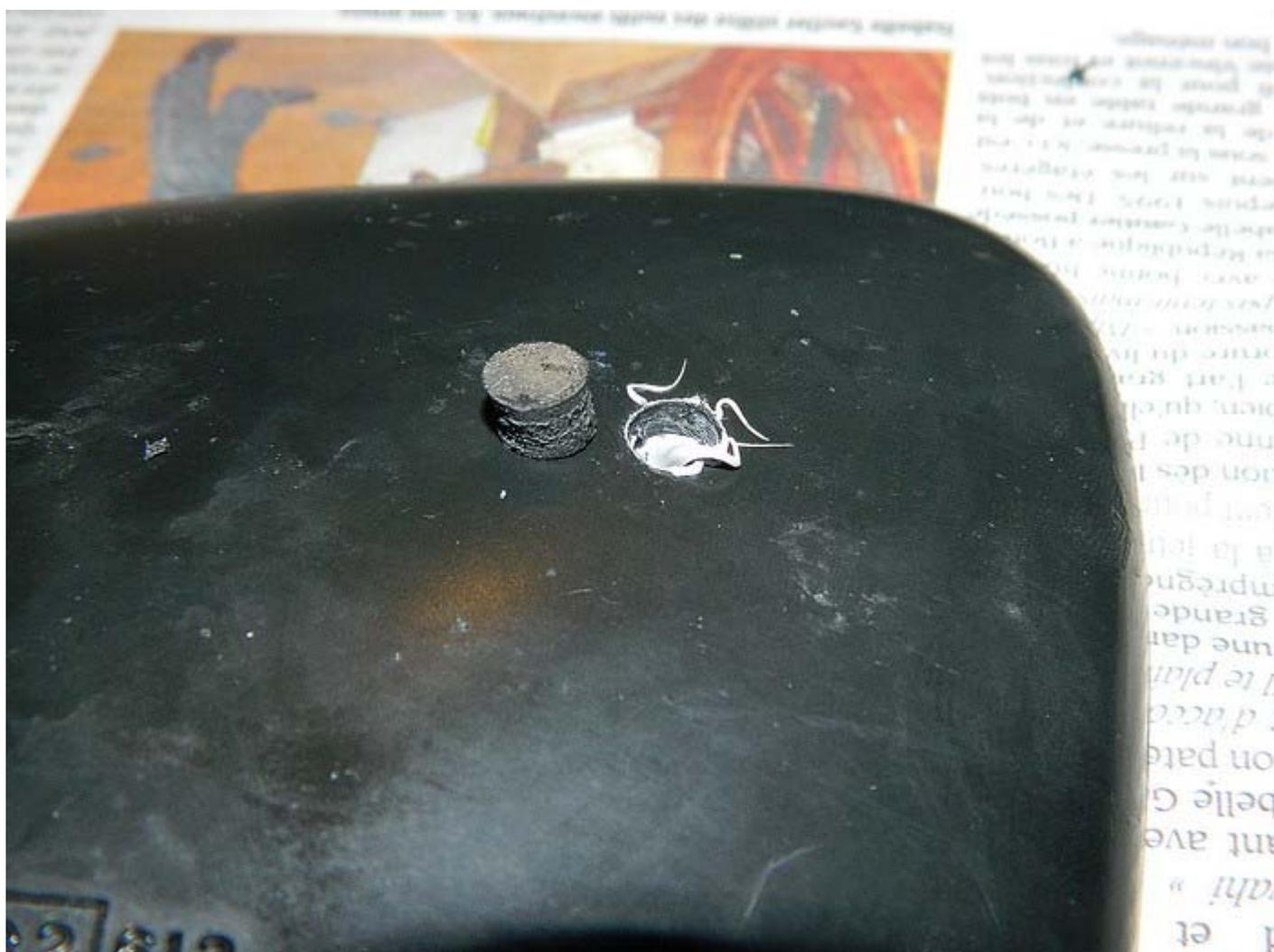
J'ai fabriqué un bouchon à l'emporte pièce dans du caoutchouc qui va tenir avec le silicone.
