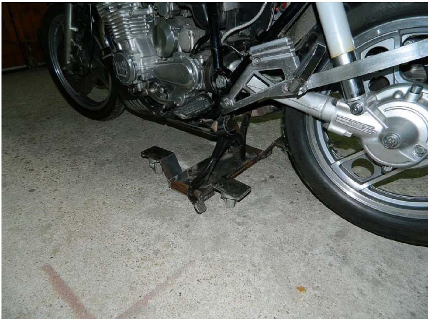
J'ai ajouté des renforts, placé du caoutchouc eps 5 mm en fond et démonté les roulettes pour graisser les roulements .
