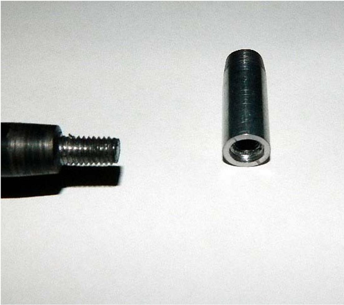
Montage avec du loctite vert avec de la tige M6
