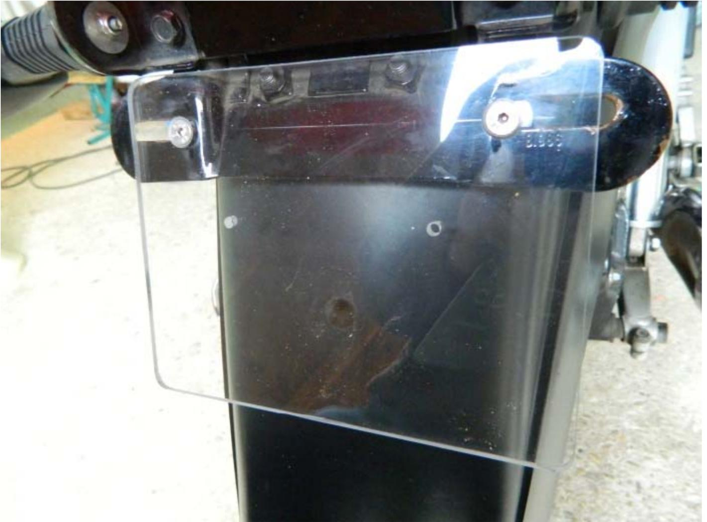
En plus j'ai collé du scotch toilé à l'arrière de la plaque pour éviter les bruits de vibration !
