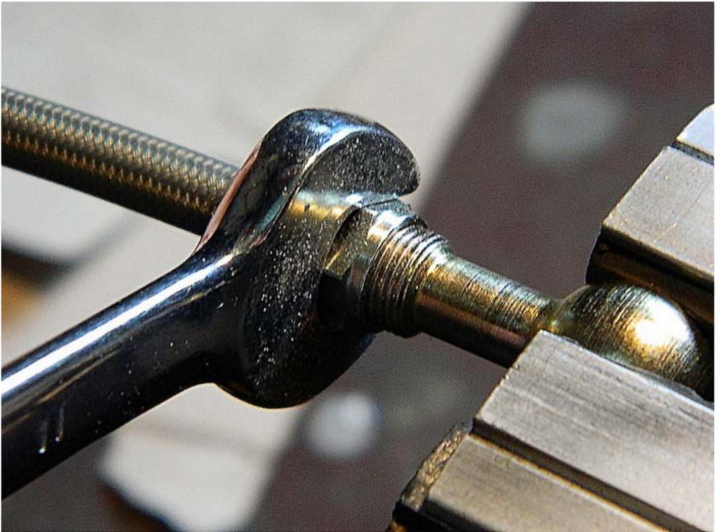
Pour bien placer la gaine thermo, commencer à retendre avec un briquet du coté de l'écrou sur 5 mm approximativement, souffler dessus pour refroidir, la pousser sous l'écrou et retendre le reste.
