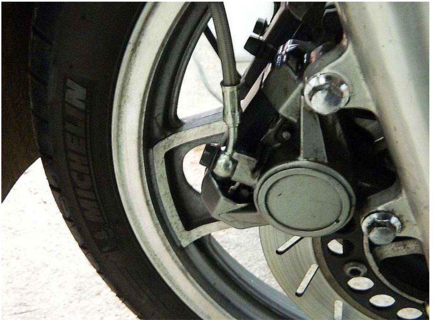
J'ai fabriqué un guide avec du fil zingué de porte manteau et de la gaine téflon .
