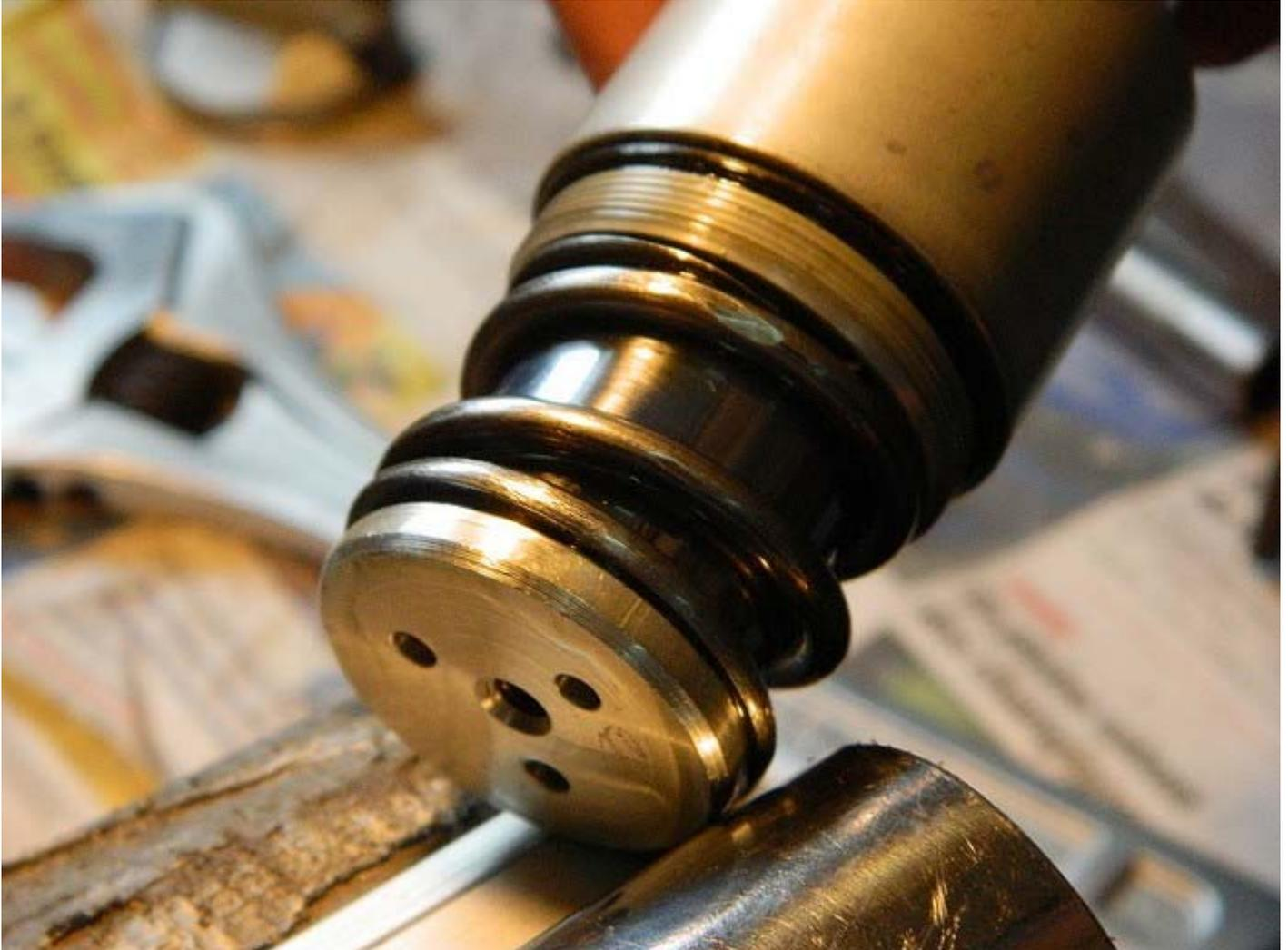
Vous remarquerez le trou dans la tête de vis dans le piston ? c'est le trou calibré pour le laminage de l'huile au retour !
