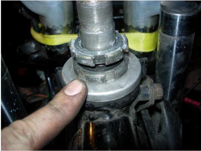
Enfin ! Vous pouvez remonter la colonne, remettre la rondelle grise au dessus du roulement supérieur. revisser l'écrou à ergot jusqu'à ce que la fourche tourne avec un tout petit peu de résistance (on y arrive en serrant à la main) puis redévisser d'un dixième de tour pour libérer totalement la direction. Remettre la rondelle en caoutchouc, puis le contre écrou et la rondelle frein. Remonter le reste du merdier en sens inverse du démontage
