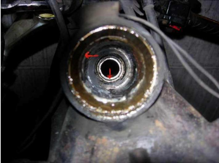
Voici une vue du tunnel de la colonne de direction. Il va falloir virer les deux cuvettes qui sont rentrées en force dedans.
