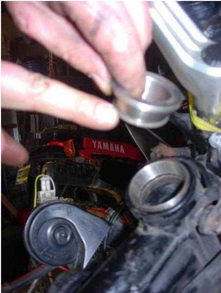
Quand vous avez viré les cuvettes, après un bon nettoyage des logements, sortez les cuvettes neuves du congélateur pour les installer.
