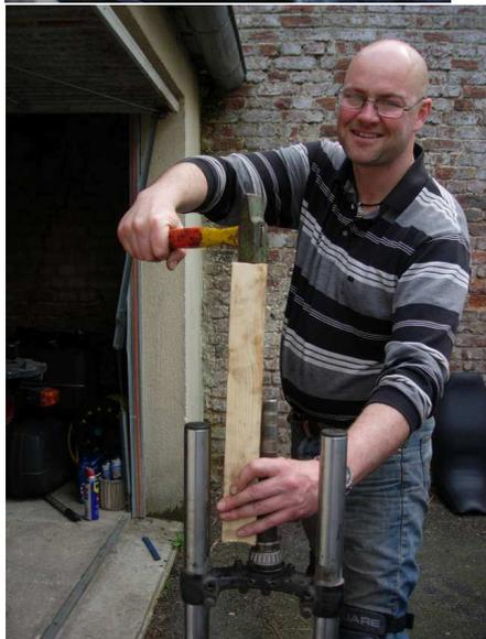
Il reste à installer le roulement inférieur sur la colonne.
