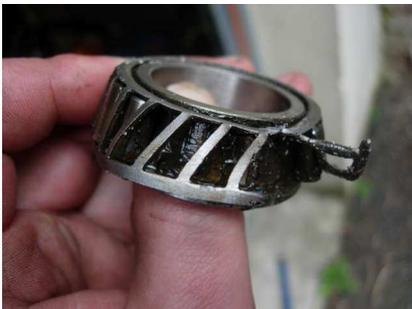
Pour la cuvette du haut, Peflo a trouvé une astuce, vu que ma douille de 30 était trop épaisse et que je n'arrivais pas à chopper la cuvette avec mon burin, il a pris le corps de l'ancien roulement que j'avais préalablement dézingué
