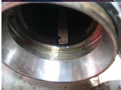
Et enfin, une autre solution pour extraire le roulement qui reste sur l'axe de direction. J'utilise une mini perceuse (type dremel) équipée d'un petit disque à tronçonner. Après avoir fait sauter les rouleaux, je fais deux entailles diamétralement opposées qui fragilise le roulement. Quelques petits coup de burin et le roulement casse facilement en deux.
