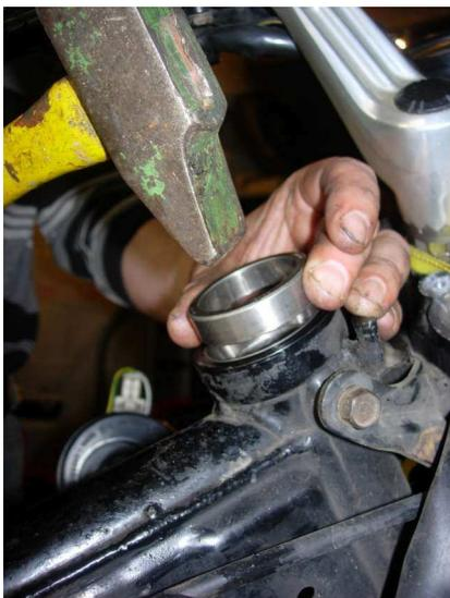
Il faut les installer au marteau. S'aider d'un bout de bois ou même des anciennes cuvettes pour que ça rentre droit sans taper directement sur les cuvettes neuves.
