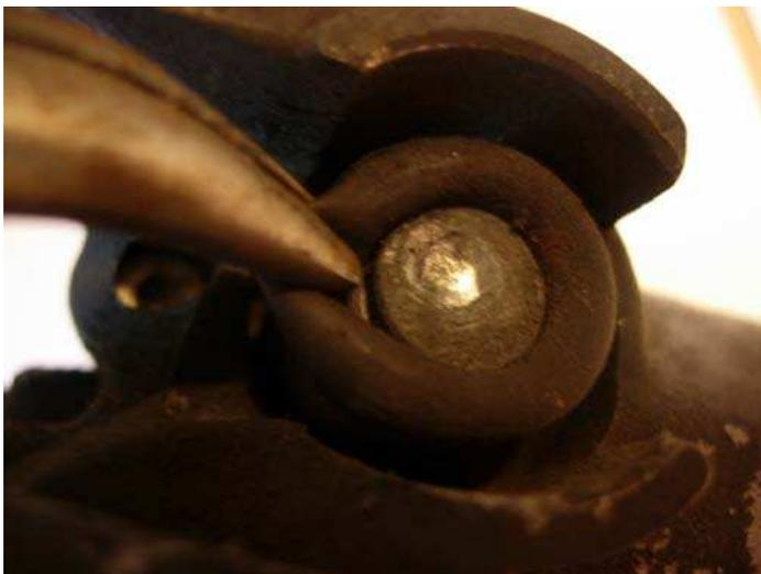
Avec une petite pince, sortir le joint. Pas de panique en cas de dégât, il sera remplacé. Il vient très facilement.
