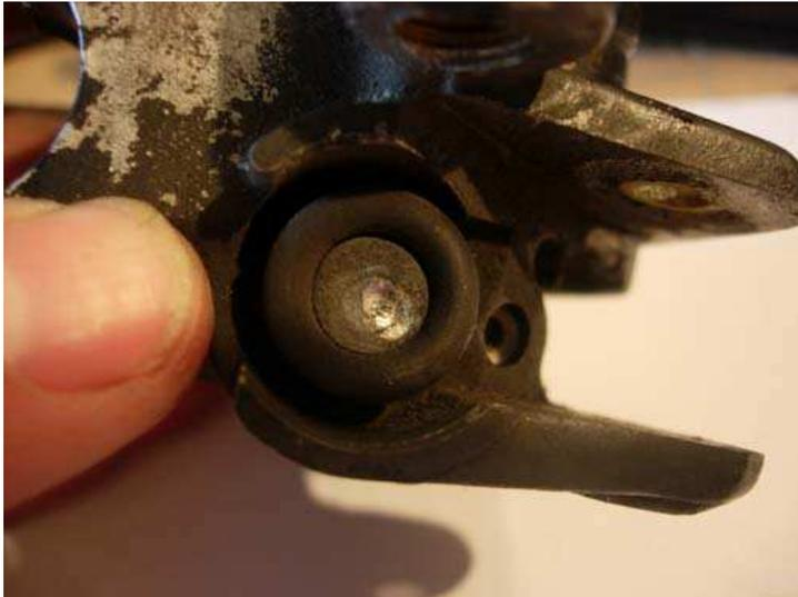
Le levier déposé, on découvre le cul du piston
