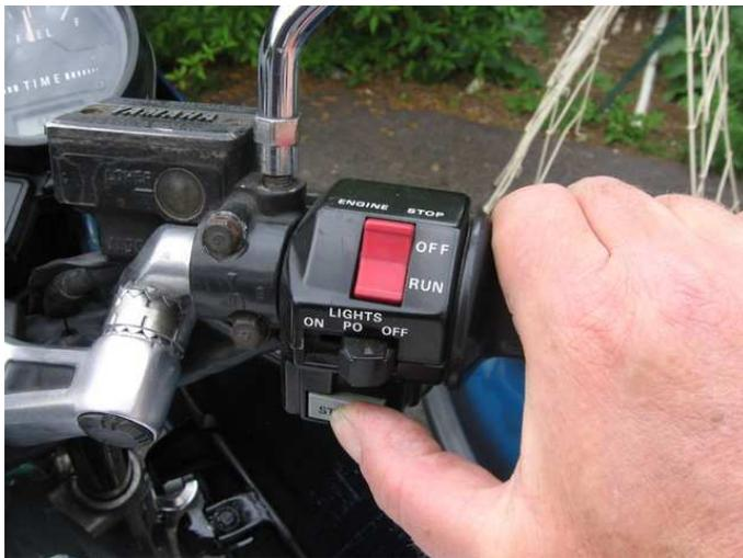
On ouvre la poignée de gaz à fond et on lance le moteur avec le démarreur jusqu'à ce que l'aiguille du compressiomètre indique un maximum (environ 4 à 5 secondes)
