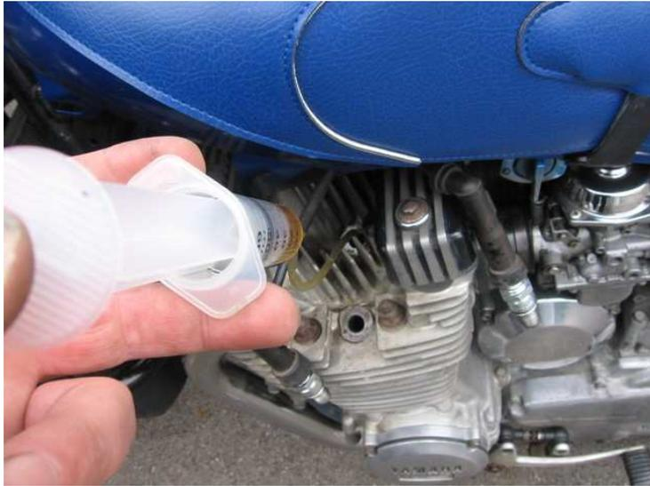
Contrôle au joint visqueux, ce qui permet de vérifier si c'est la segmentation qui est en cause
