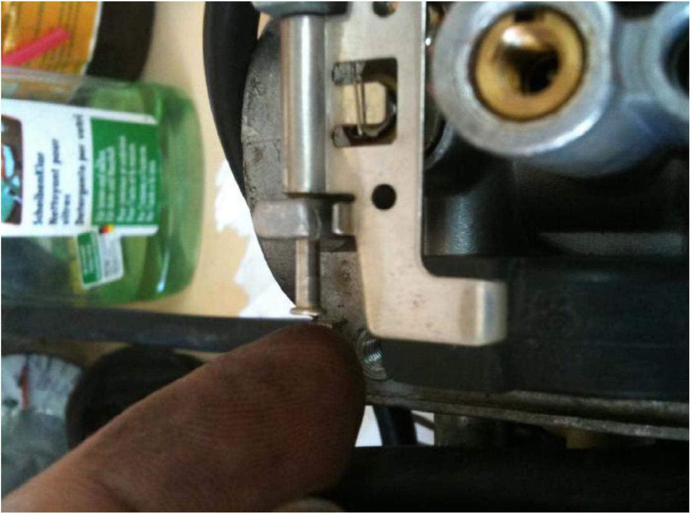
Lorsque l'axe est sorti, on peut virer le flotteur en faisant attention de ne pas perdre de pièce (la pièce qui pend ici est le pointeau).
