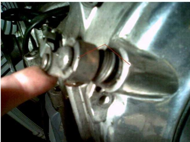
Enclencher le tout et vérifier quand repoussant le levier avec le doigt il bloque au niveau des deux repères
