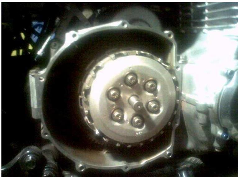
A l'aide d'un tournevis plat retirer les disques garnis et lisses. Vous devez voir maintenant un disque lisse pris avec un fil de fer, STOP on ne touche pas à celui la.
