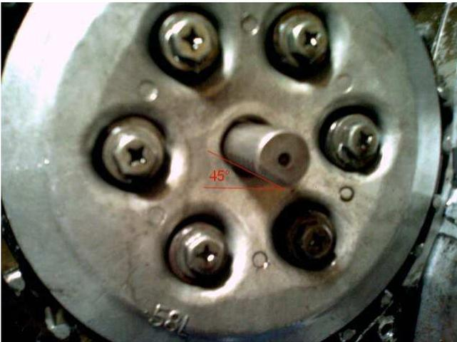
Placer le joint, pour le faire tenir correctement mettre un tout petit peu de graisse. Ensuite quand vous êtes face à la coche d'embrayage tourner la crémaillère (partie métallique au centre de la cloche d'embrayage) pour que les crans soient dirigés en bas et vers la gauche (45° par rapport au sol)
