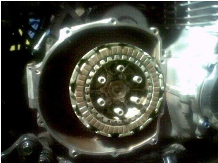
Il vous faut une lame de cutter, un petit tournevis plat et du papier à eau. Ah oui et beaucoup d huile de coude si c'est vraiment collé comme le mien. Enlever le plus gros avec la lame de cutter. Pour les contours des deux pas de vis qui ressortent prenez le petit tournevis, et pour finir frotter le tout avec le papier à eau.
