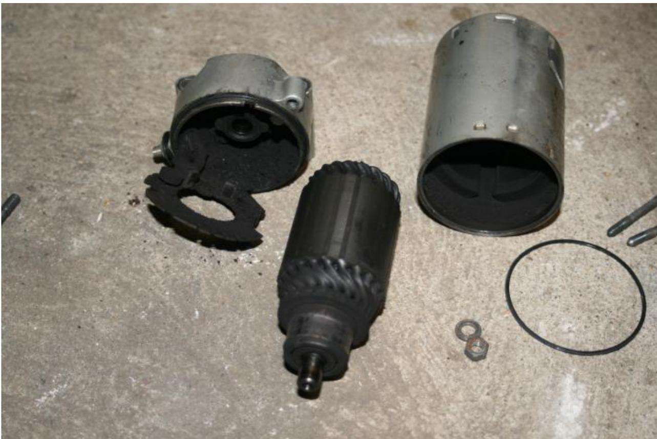
**Vue des aimants permanents dans le stator :**
