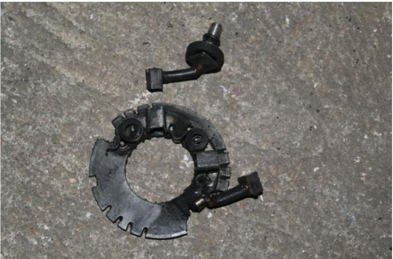
La platine après nettoyage & dégraissage à l'acétone :
