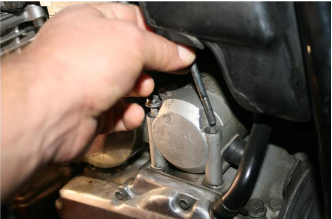
**La vis gauche, plus longue, ne peut pas être retirée. Il faut la retirer avec le démarreur :**
